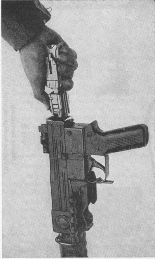
Bild 22 Einführen des Verschlusses
